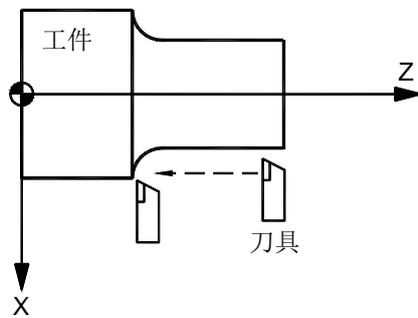
程序指令：**G02 X\_\_ Z\_\_ R\_\_**；或 **G03 X\_\_ Z\_\_ R\_\_**；
