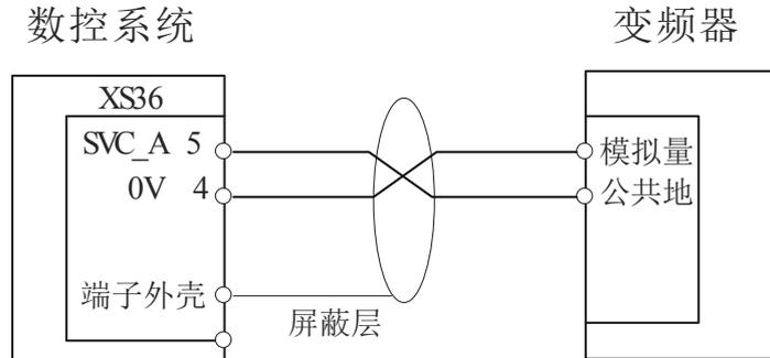
B. B 通道模拟量输出接线图：
