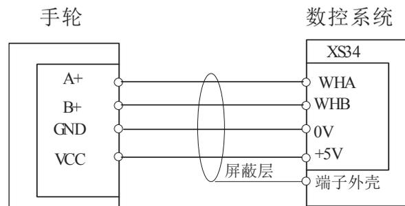
根据输出信号模式不同，一般有两种类型手轮：两信号线式（A+，B+信号）和四信号线式（A+，A-，B+，B-）。对于四信号线手轮，A-，B-信号不接。
