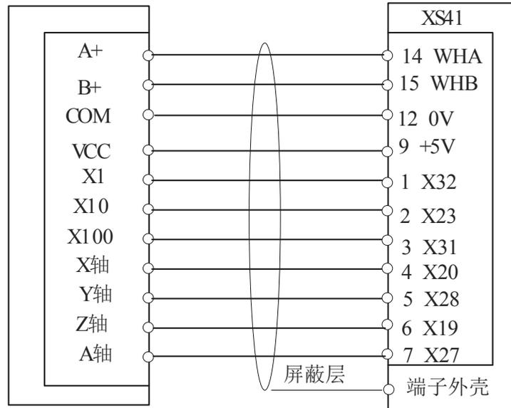
注： 根据信号输出模式不同，一般有两种类型手轮：两信号线式（A+， B+信号）和四信号线式（A+， A-， B+， B-）。对于四信号线手轮，A-， B-信号不接。
