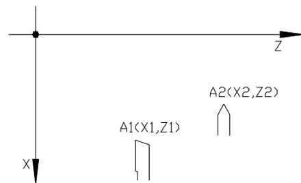
刀补值。在实际应用中，为了简化这一过程，数控系统不是测出各把刀两两之间的差值，而采取更简洁的方法来记忆刀补值，即记忆刀尖位置坐标值的方法来确定。
