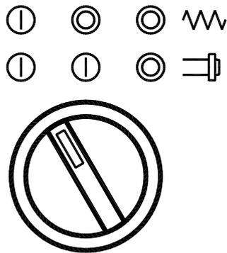
面板上的三位开关分左侧、中间、右侧三个位置状态，当由左侧位置拨到右侧位置，再由右侧位置拨到左侧时其控制顺序为：
