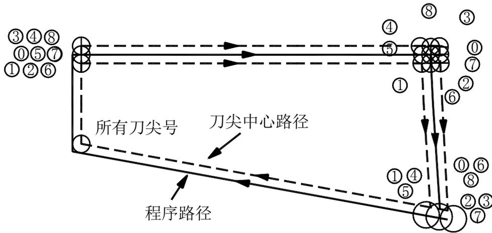
图 6-2-6-1 G90 刀尖半径半径补偿
