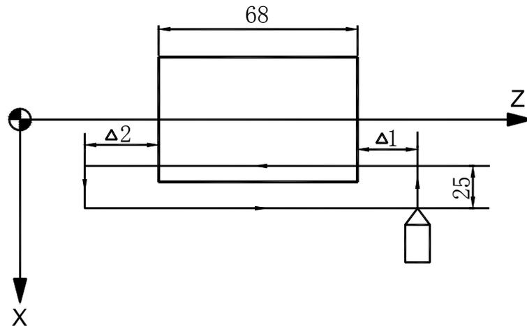
在 Z 方向： $\Delta 1=3\text{mm}$ ， $\Delta 2=1.5\text{mm}$
