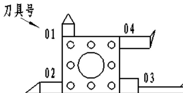
加工时需要选择粗加工，半精加工，精加工，切螺纹，切槽等各种刀具。各种刀具都带刀号，当程序中指定这个刀具号时，就自动选择对应的刀具。
