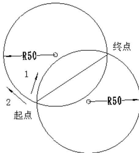
如下图所示，刀具进行圆弧插补：
