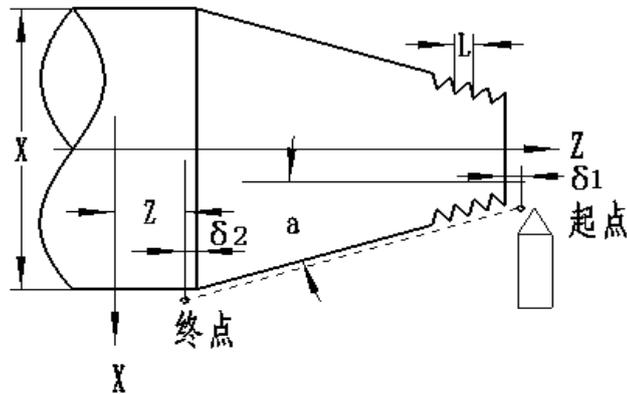
假设螺纹导程 4mm，螺纹起点坐标 (15, 40)，螺纹终点坐标 (30, 10)，
