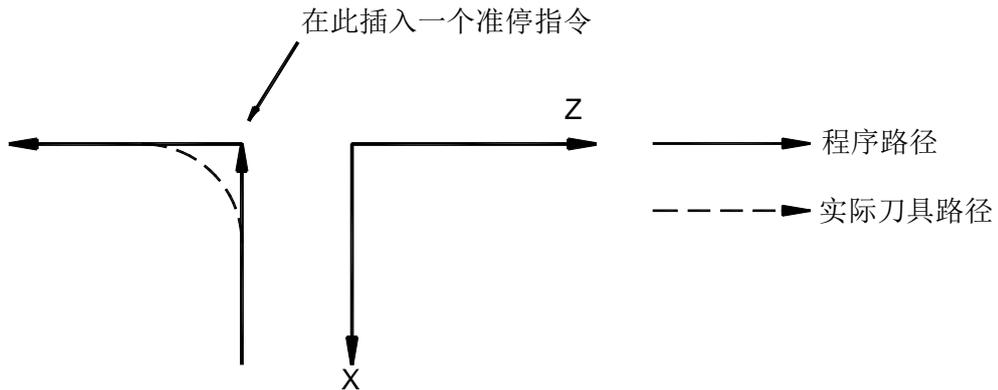
如果加入准停指令, 则刀具沿着上图实线那样按程序指令运动。否则, 切削进给速度越大, 或加减速时间常数越长, 或段间速度过渡参数值越大, 则拐角处的弧度也越大。圆弧指令时, 实际刀具轨迹的圆弧半径比程序给出的圆弧半径小。要拐角处误差变小, 在机械系统允许的情况下, 应使加减速时间常数尽量变小。
