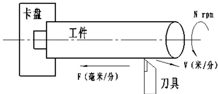
把切削工件时刀具相对工件的速度称为切削速度。CNC 可以用主轴转速来指令这个切削速度。
