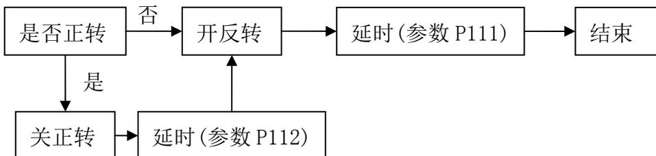
(1) M04 指令使主轴反转继电器(由 M04 输出口控制)吸合,接着 S 功能输出模拟量,控制主轴逆时针方向旋转。
