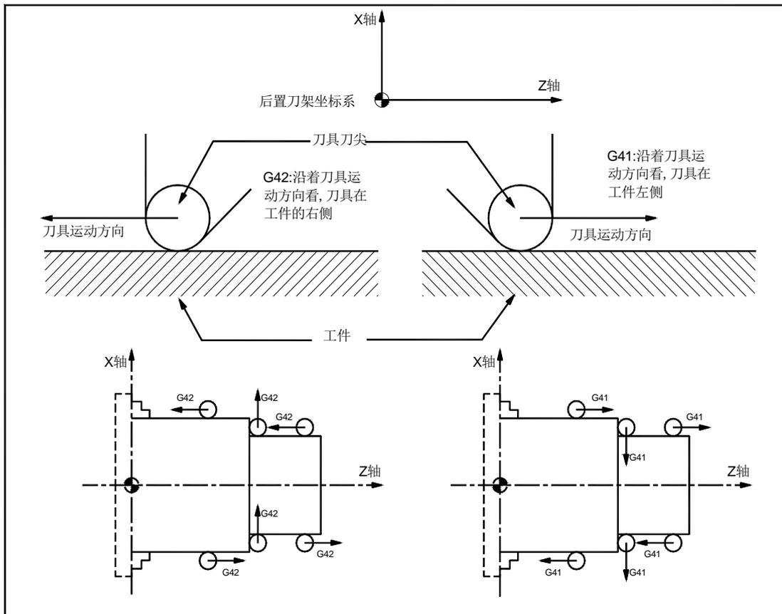
图 6-1-4-1 后刀座坐标系中刀尖半径补偿
