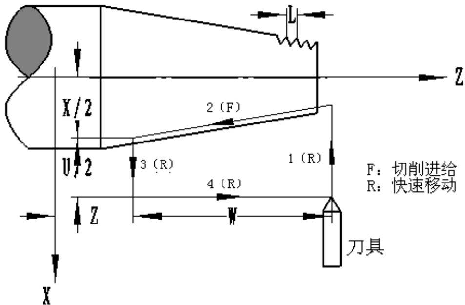
快速定位→等待头脉冲→切削进给→快速退尾→快速回刀
