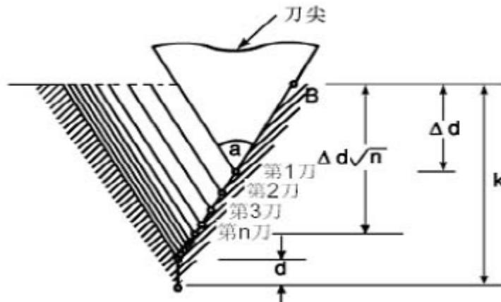
例: G76 螺纹复合切削循环示例:
