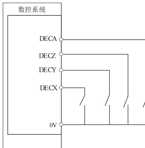
其中： X 轴减速开关输入口（DECX）由参数 P254 定义
