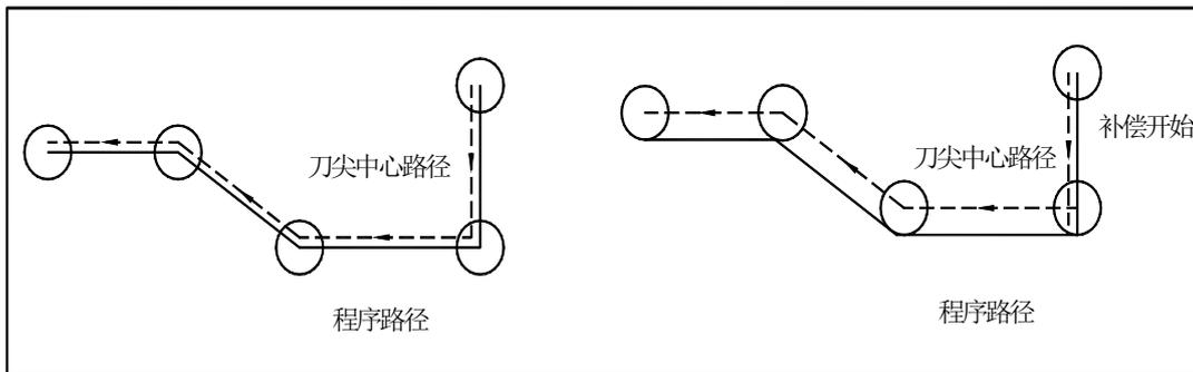
图 6-1-1-3 以刀尖中心编程时的刀具轨迹
