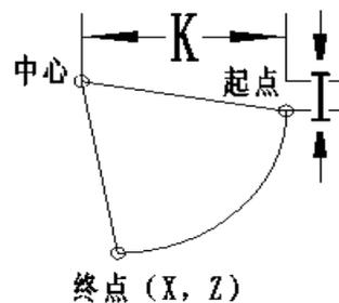
**I**、**K** 根据方向带有符号。圆弧中心除用 **I**, **K** 指定外, 还可以用半径 **R** 来指定。如下:
